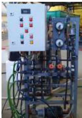
Рисунок 2 – Пилотная установка обратного осмоса
